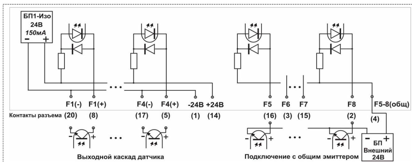
Рисунок 4 – Входные сигнальные цепи частотных каналов
