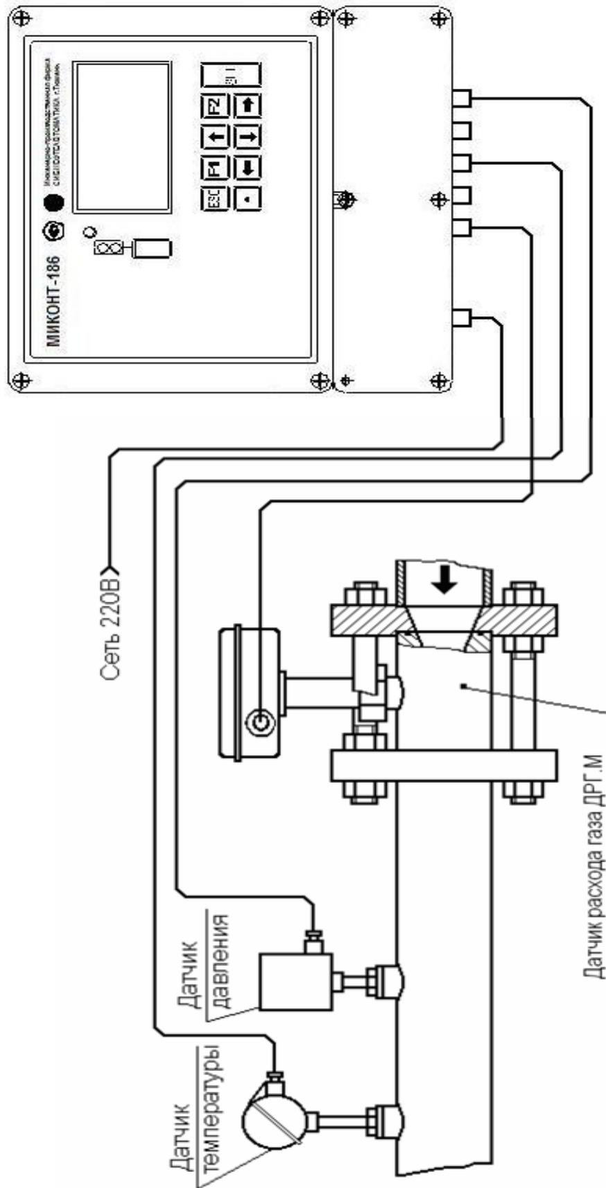
Рисунок В.1 – Счётчик газа вихревой СВГ.М
