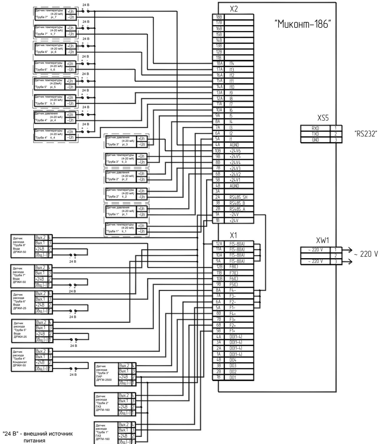
Рисунок Г.3 - Контроллер с подключенными датчиками
