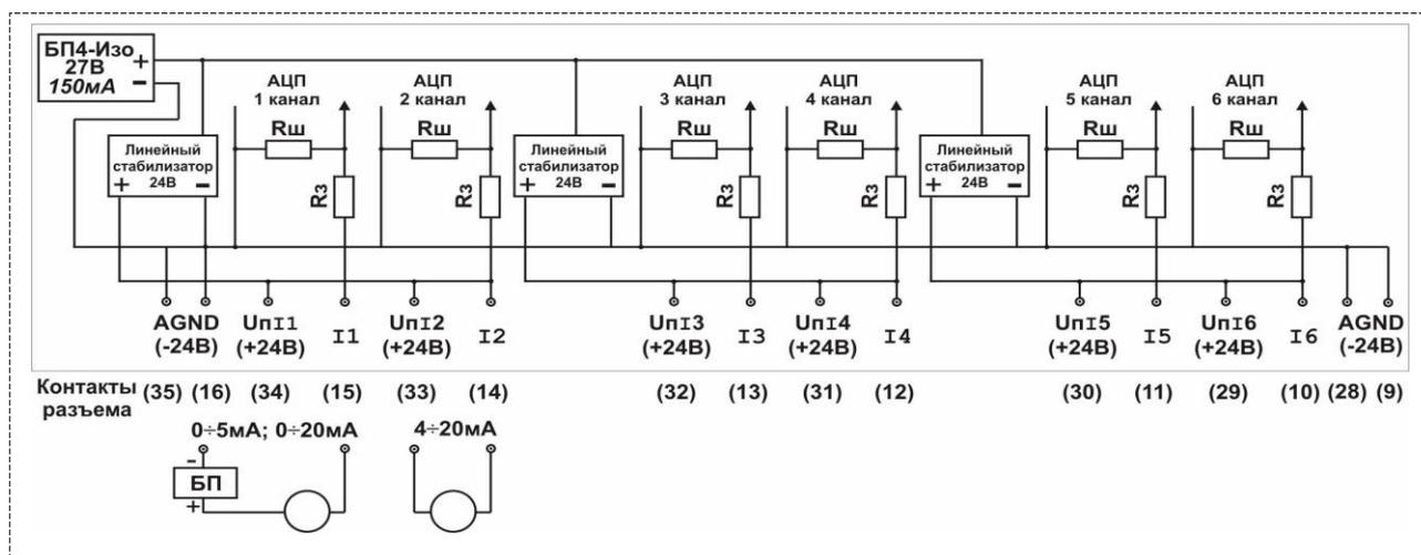
Рисунок 5 – Входные сигнальные цепи токовых каналов
