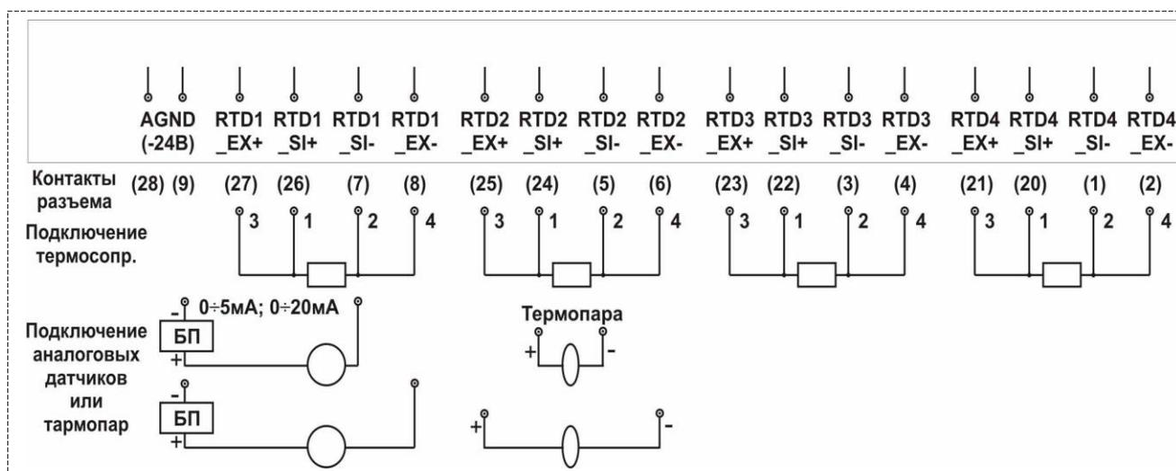
Рисунок 6 – Входные цепи каналов термопреобразователей
