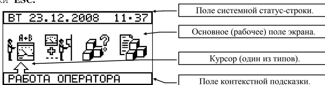
Рисунок 7 - Общий вид "ГЛАВНОЙ" панели на дисплее контроллера
