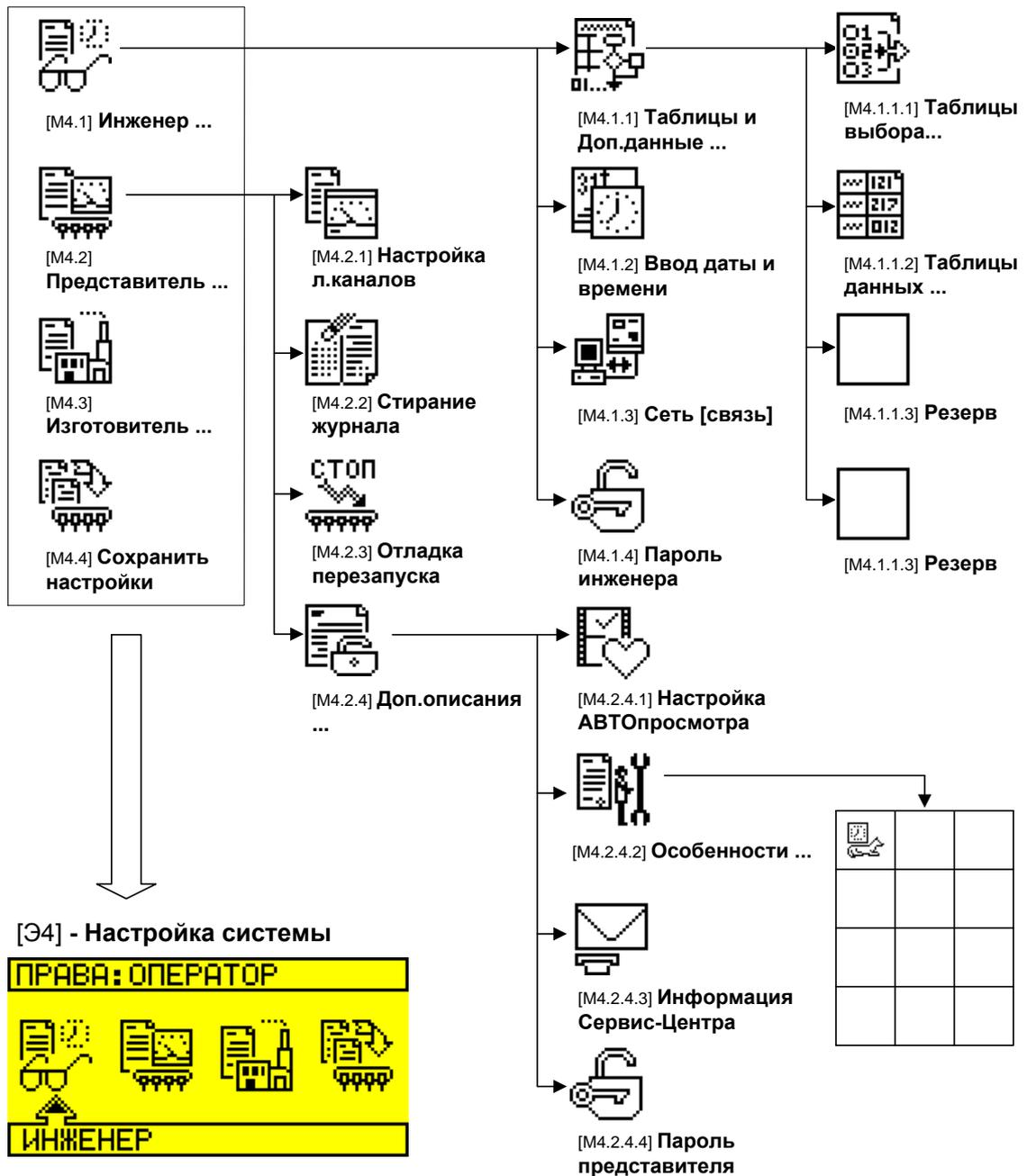
Рисунок Б.2 – Меню настройки системы контроллера
