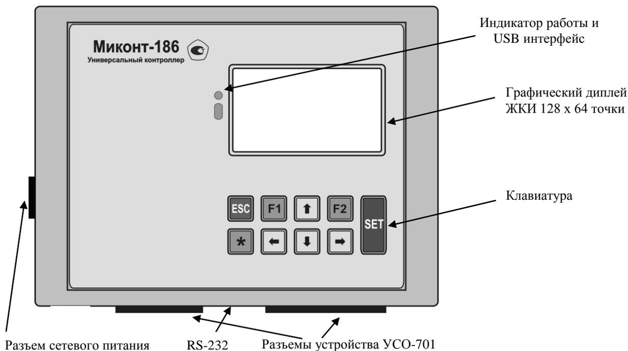
Рисунок 1 – Внешний вид контроллера МИКОНТ-186 (без БКС-701)
