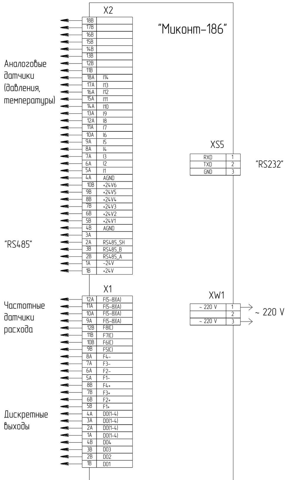
Рисунок Г.1 – Контроллер с параметрами УСО-701:
