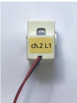
Маркировка токового трансформатора (2 канал, фаза L1 (A))
