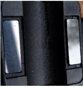
На магнитопроводе видны отпечатки пальцев и пыль. Точность измерений будет низкой
