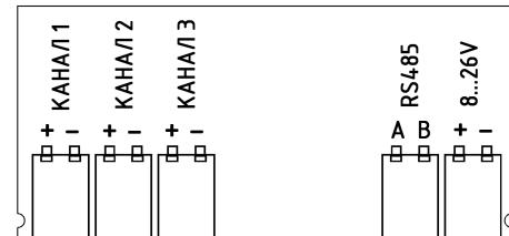
Подключаемые преобразователи с активной выходной цепью (энергия в цепь поступает со стороны преобразователя) должны иметь высокий уровень напряжения от 1,5 до 3В и низкий уровень не более 0,6В. При использовании преобразователей с большим уровнем сигнала рекомендуется использовать пассивный делитель напряжения. Потенциальный провод активной выходной цепи должен быть подключен к контактам «+» клеммников каналов, общий провод к контактам «-» клеммников каналов.
