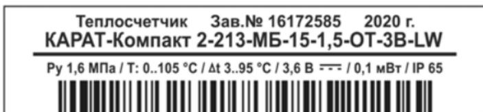
**Рисунок 6** – Пример маркировки теплосчетчика
