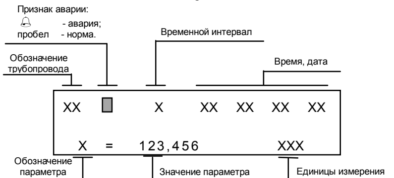
Рис. 2.7. Назначение знакомест индикатора тепловычислителя при работе в основном режиме
