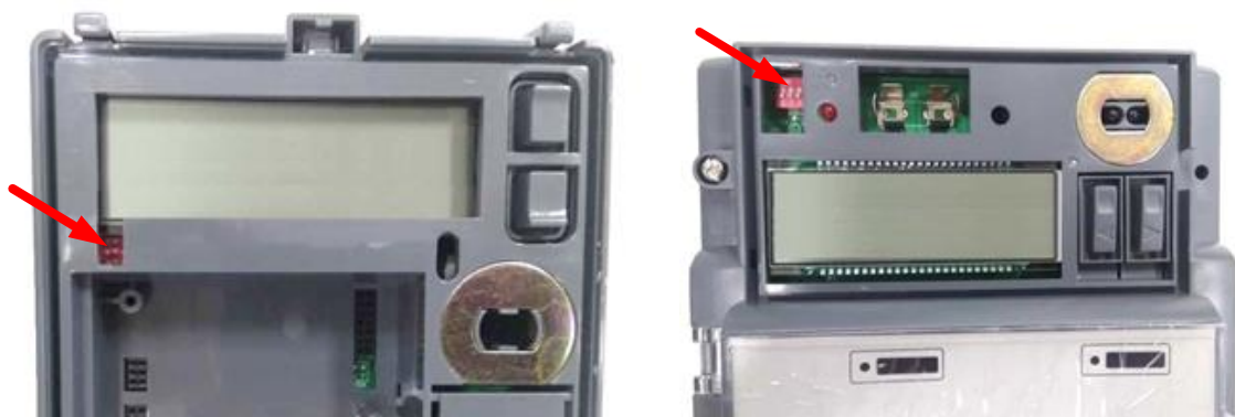
Рисунок 3.1 – Расположение переключателя блокировки управления нагрузкой счетчиков «Меркурий 204» (слева) и «Меркурий 234» (справа)
