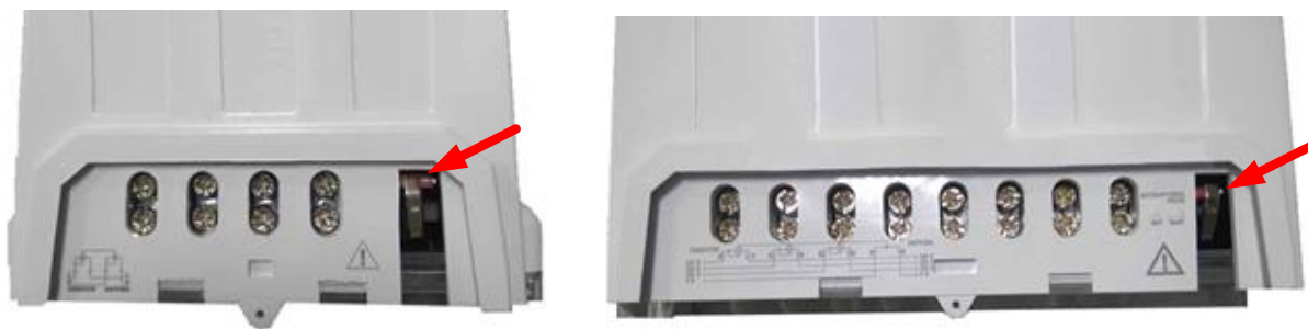
Рисунок 3.2 – Расположение переключателя блокировки управления нагрузкой счетчиков «Меркурий 208» (слева) и «Меркурий 238» (справа)
