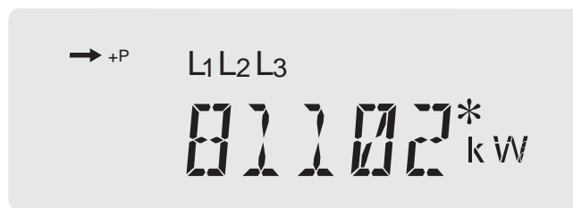
Рисунок 4.5 – Пример отображения на ЖКИ активной мощности в киловаттах
