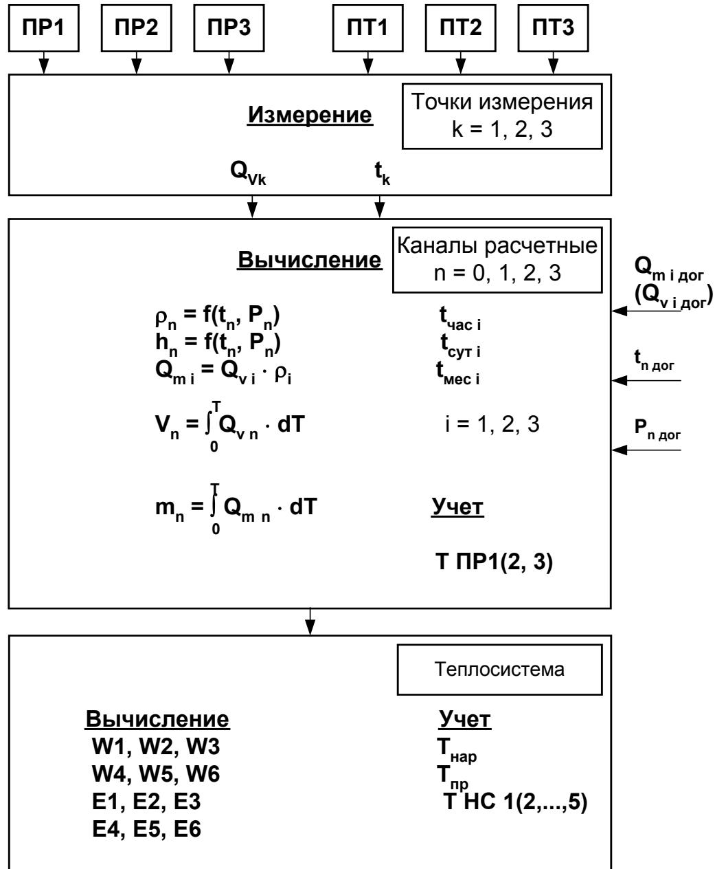
где  $Q_{m i \text{ дог}}, Q_{v i \text{ дог}}, t_{n \text{ дог}}, P_{n \text{ дог}}$  – договорные значения параметров;
