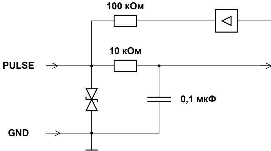
В пассивном режиме на вход должны подаваться импульсы напряжения с параметрами: логический ноль – 0 ... 0,5 В, логическая единица – 3,0 ... 5,0 В.
