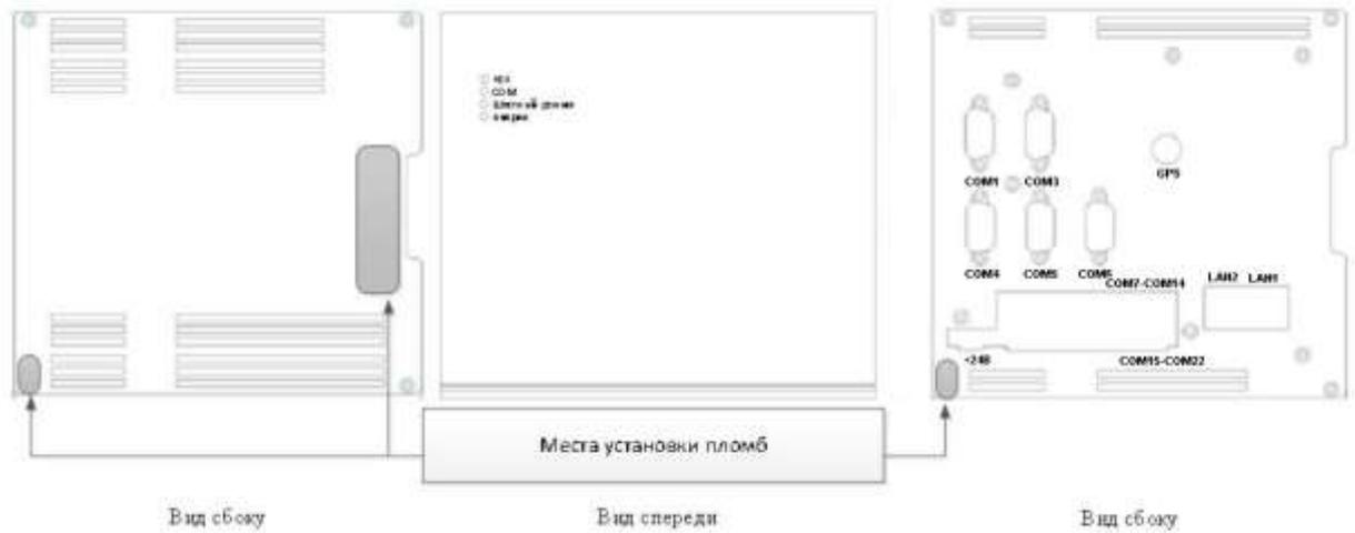
Рисунок Е.1 – Расположение разъемов и схема пломбирования УСПД исполнения Т
