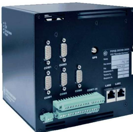
Рис. 1.3 – УСПД в корпусном исполнении Т
