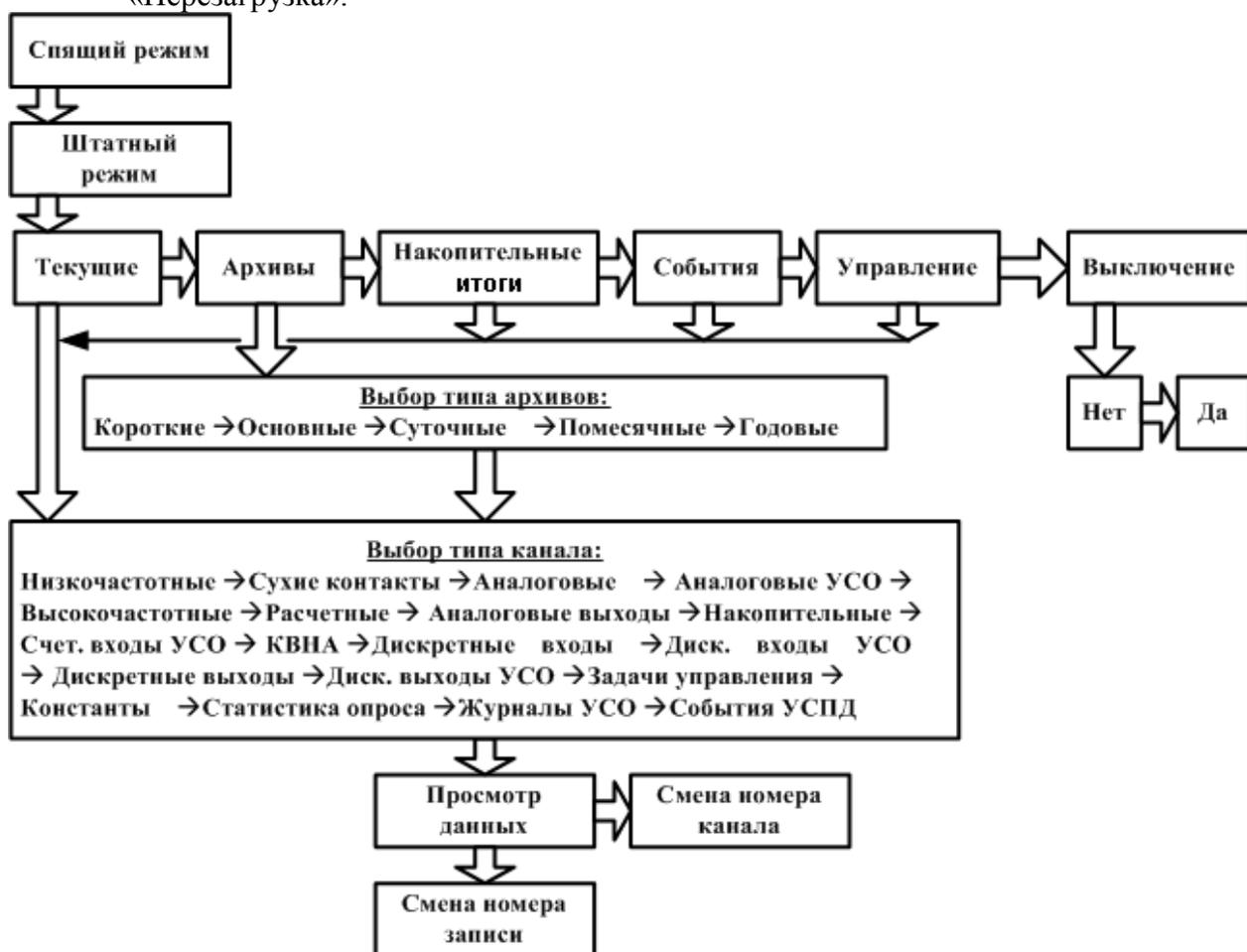
Рис. 1.4 – Структура меню УСПД (общий случай, «Штатный режим»)
