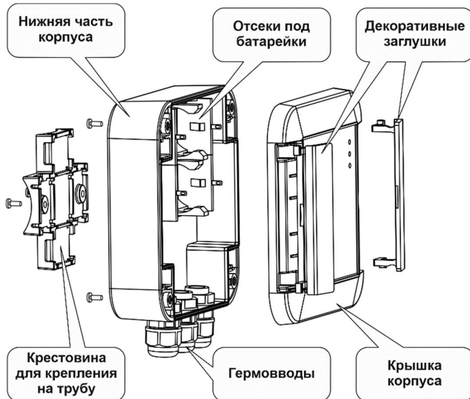
Рис.1. Конструкция терминала
