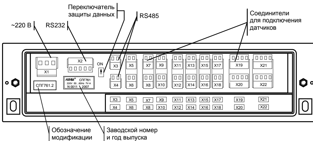
Рисунок 3.2 – Монтажный отсек (крышка снята)
