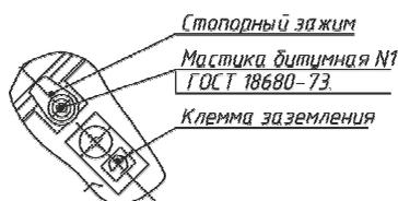
Рисунок Е.1 – Чертеж средств взрывозащиты блока электронного БЭ-020
