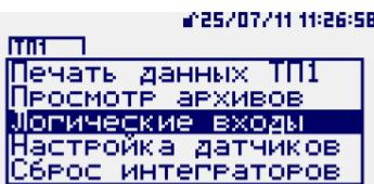
Для просмотра состояния логических входов, использованных в выбранном трубопроводе, необходимо выбрать при помощи клавиатуры **▲**, **▼** пункт меню *Логические входы* и нажать кнопку **►**. На индикаторе появится следующее окно:
