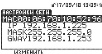
Для вычислителя в локальной сети Ethernet необходимо выделить фиксированный IP адрес и назначить маску подсети согласно выбранной сетевой конфигурации. Если у Вас вызывает затруднение назначение адреса или маски подсети для вычислителя, обратитесь к соответствующей литературе или к сетевому администратору Вашего предприятия.
