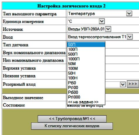
Тип датчика температуры выбирается из приведенного списка. Обозначения датчиков температуры соответствуют типам термопреобразователей по ГОСТ 6651-2009.
