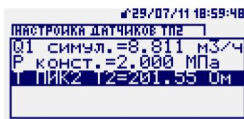
Режим предназначен для проведения настройки датчиков. При работе в этом режиме вычислитель регистрирует факт проведения настройки в архиве как НС и в течение всего времени проведения настройки производит расчет расхода по договорному значению, заданному в карте параметров соответствующего трубопровода. В этом режиме можно просмотреть те же параметры, что и в подпункте *Проверка физических входов*, но в привязке к выбранному трубопроводу.
