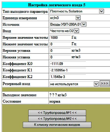
Коэффициенты плотномера Solartron, учитывающие значение давления и температуры, описываются в трубопроводе, в котором используется логический вход с таким плотномером.
