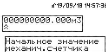
В этом окне при помощи кнопок клавиатуры ▲, ▼, ▶, ◀ установите значение механического счетчика и нажмите кнопку *Ввод*. Произойдет одновременный сброс интеграторов и установка заданного значения механического счетчика в интеграторе количества в вычислителе.
