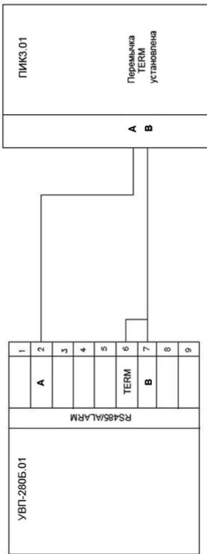
Схема соединений БВ и нескольких ПИК3.01 в вычислителях УВП-280Б.01
