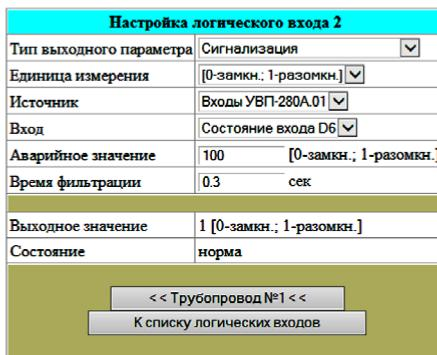
Вход сигнализации используется для описания датчиков с выходом «замкнуто-разомкнуто», подключаемых для оповещения о несанкционированном доступе к узлу учета. Эти датчики подключаются к дискретным входам D1 ... D6. Параметр «Время фильтрации» устанавливается для фильтрации «дребезга» контактов при подключении механических или герконовых датчиков и равен минимальному времени между переключениями датчика.
