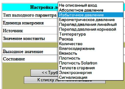
Один логический вход может использоваться в описании разных трубопроводов. Для возврата к описанию параметров трубопровода необходимо щелкнуть мышкой на окно соответствующего трубопровода в окне *Настройка логического входа N*.
