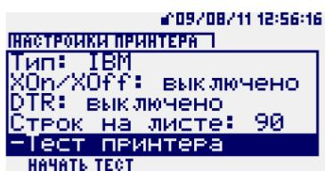
После нажатия кнопки *F1* (функция *Начать тест*) выполняется печать проверочной страницы. На выводимой при тестировании странице строки пронумерованы, что облегчает определение числа строк, помещающегося на странице.
