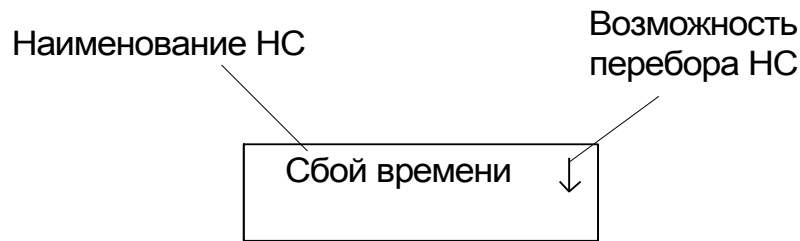
Рис.5. Вид окна индикации информации о событиях и неисправностях.
