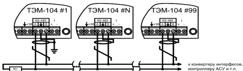
1. Согласующее сопротивление  $R_n$  устанавливается в крайних точках линий связи и должно быть равно волновому сопротивлению кабеля.
