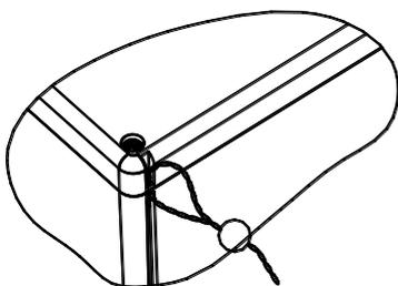
Пример пломбирования ТС на трубопроводе
