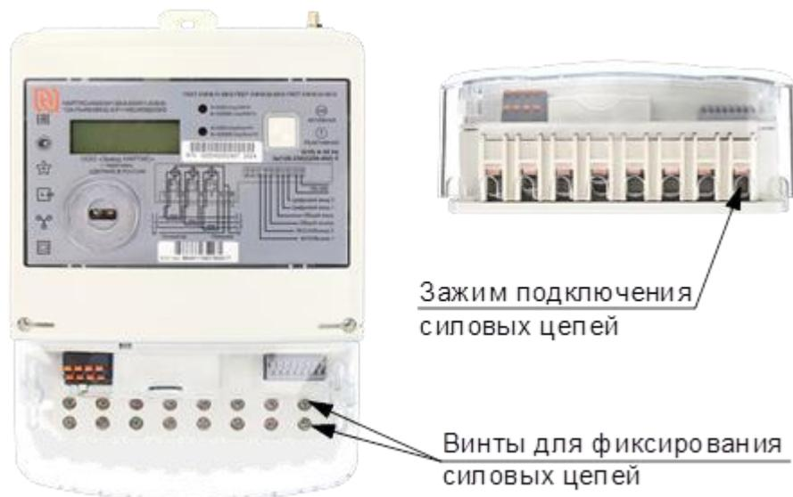
Рисунок Д.2 – Расположение зажимов и винтов для подключения силовых цепей счетчика в корпусе типа W132
