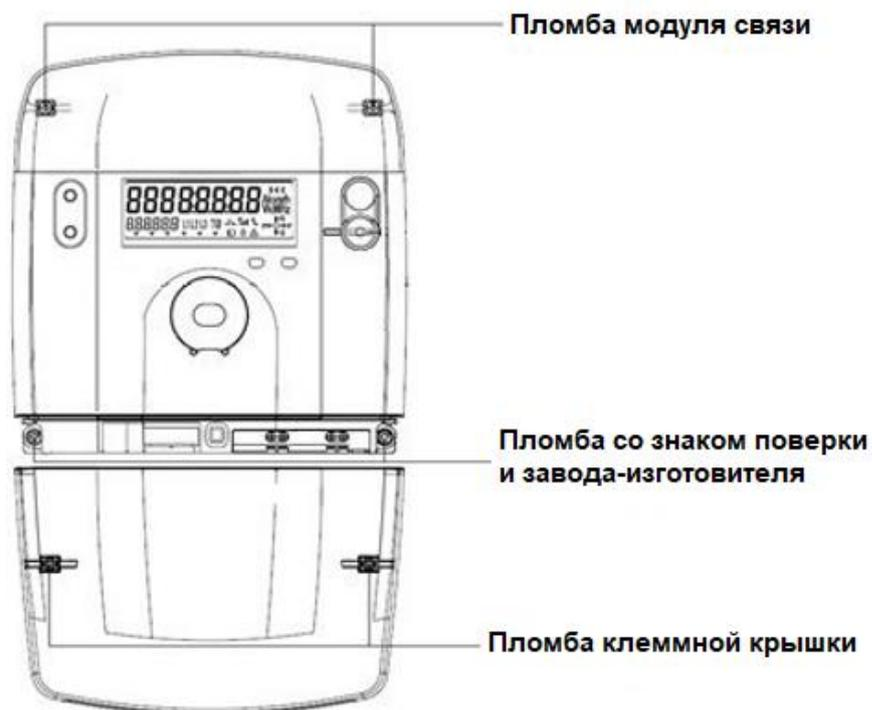
Рисунок 4 – Схема пломбирования счетчика в корпусе типа W131
