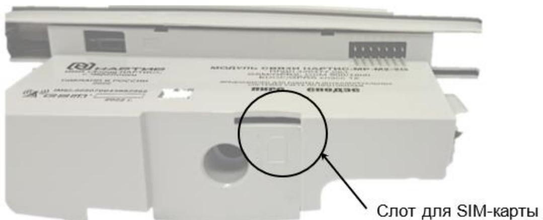
Рисунок М.2 – Расположение слота SIM-карты в корпусе модуля связи НАРТИС-МР-М2.3
