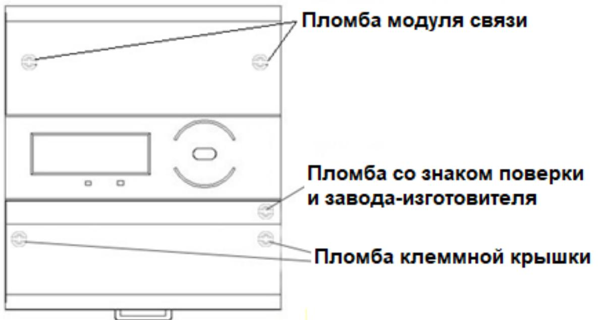
Рисунок 6 – Схема пломбирования счетчика в корпусе типа W133
