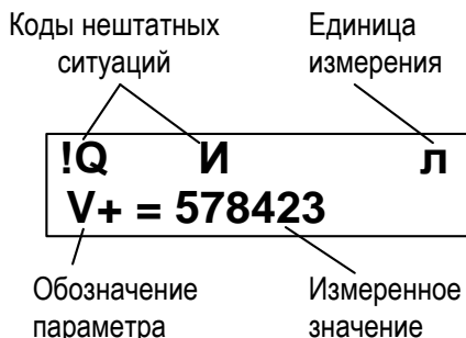
Рис.4. Размещение информации на индикаторе расходомера.
