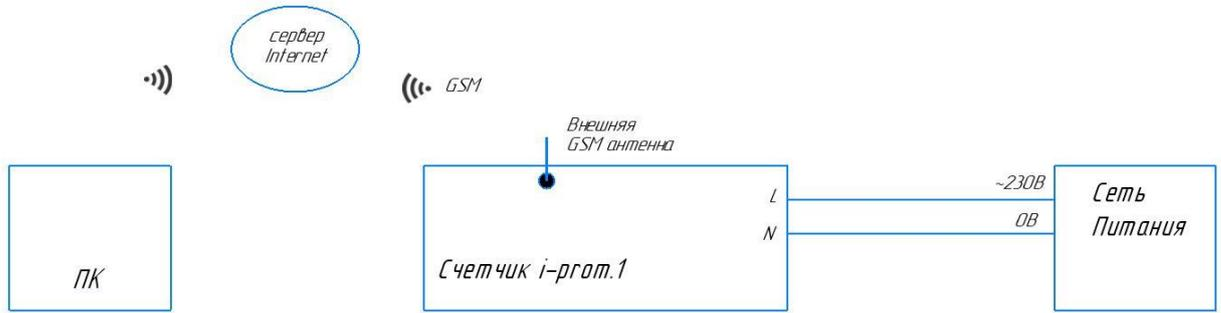
Рисунок В.7 – Схема подключения счетчика к ПК через интерфейс GSM
