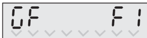
Рисунок 2.72 – Режим работы с одним счетным входом
