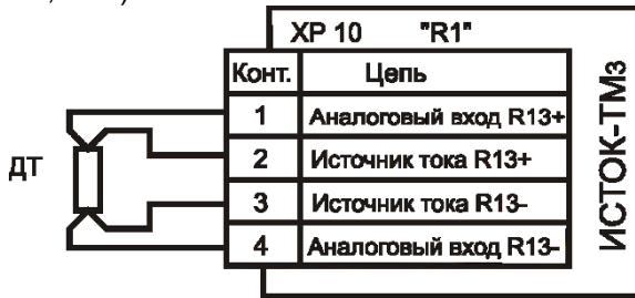
Рисунок 1.4 – Пример подключения ДТ к ИВх «13» вычислителя
