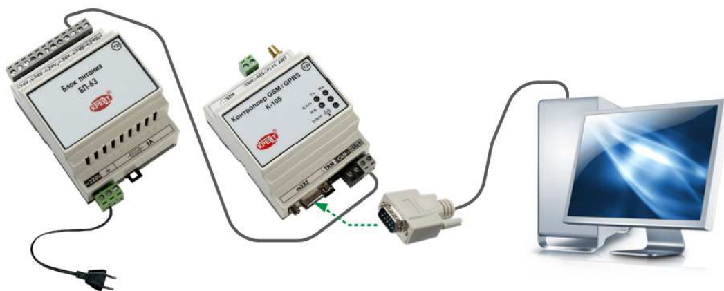
Рисунок 8. Подключение контроллера к компьютеру по интерфейсу RS-232
