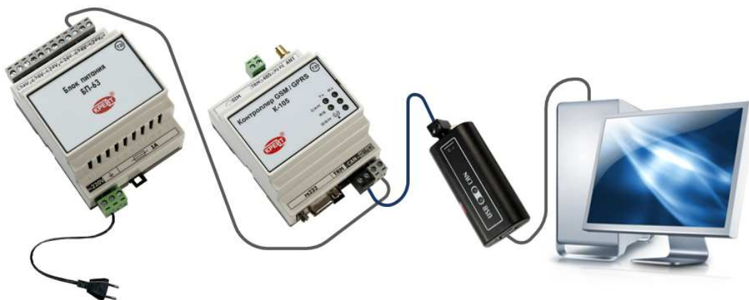
Рисунок 7. Подключение контроллера к компьютеру по интерфейсу CAN-BUS
