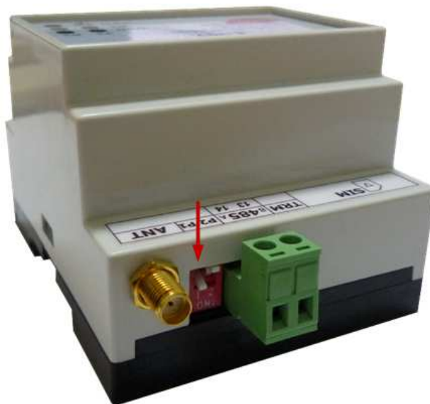
Рисунок 52. Установка движкового переключателя 1 в положение ON
