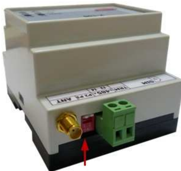
Рисунок 49. Установка движкового переключателя 1 в положение OFF
