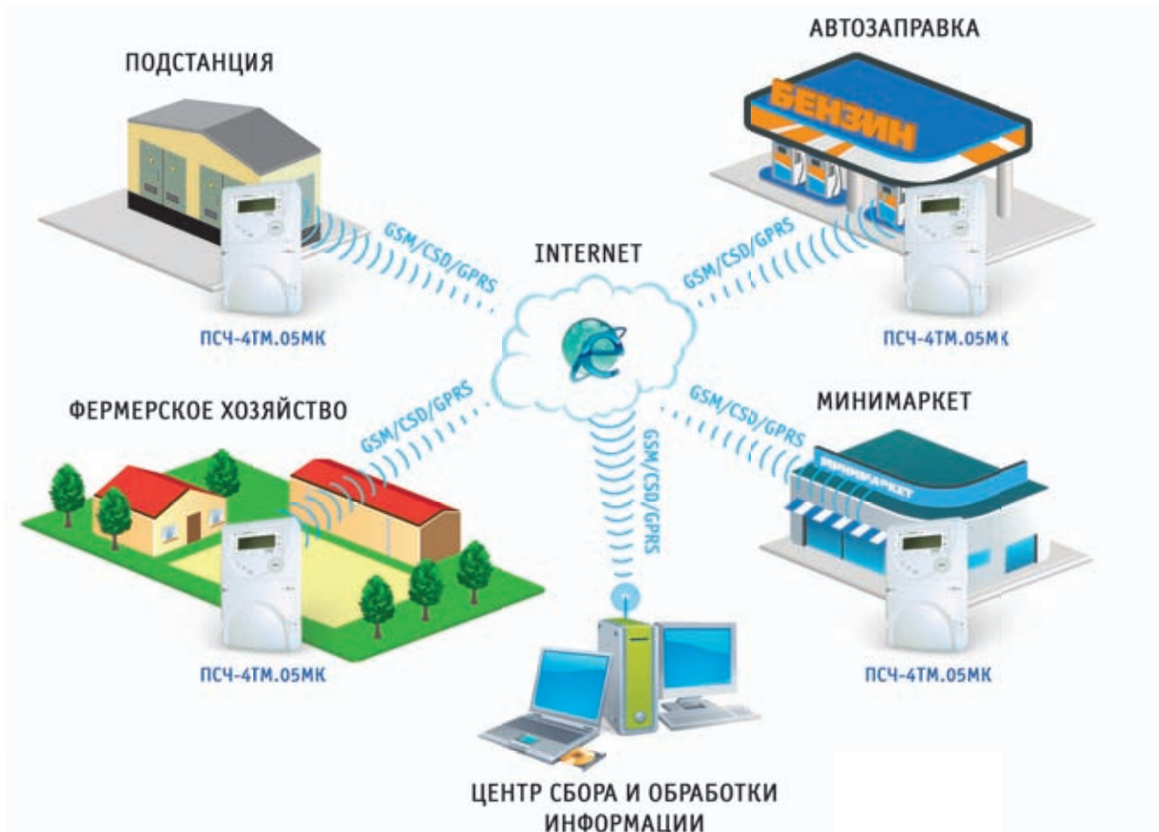
Вариант организации АИИС КУЭ на базе КТС «Микрон» с использованием GSM/CSD/GPRS
